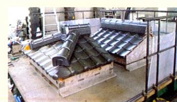
耐震補強工法 実験の様子
